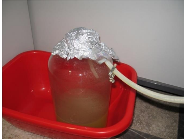
Φωτογραφία 2. Τμήμα του χημειοστάτη αποτελεί η φιάλη συγκέντρωσης του υγρού που συνεχώς απορρέει από το δοχείο καλλιέργειας.
