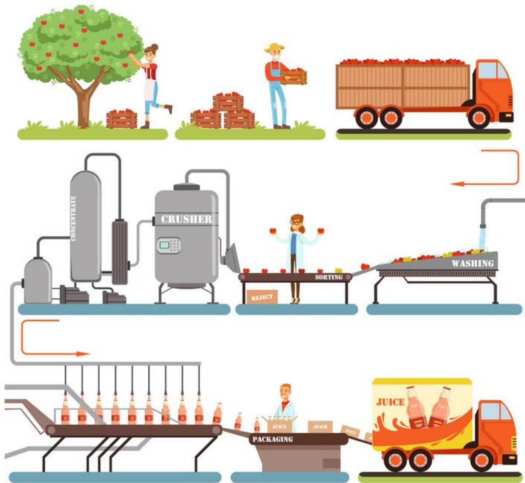
Εικόνα 6. Σχηματική απεικόνιση των βημάτων παραγωγής χυμού μήλου
