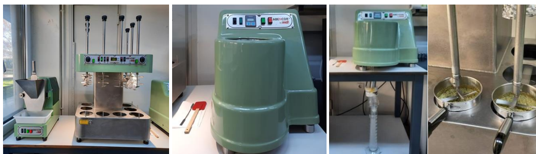
Σχήμα 4.3: Μάλαξη ελαιόπαστας σε ελαιοποιητή Abencor mc2.
