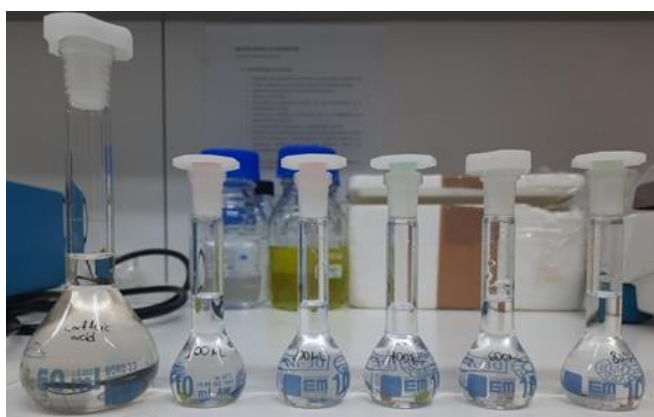
Σχήμα 4.7: Πρότυπο διάλυμα εργασίας καφεϊκού οξέος (1000μg/mL) και διαλύματα βαθμονόμησης (10,14, 20,28, 40,56, 60,84 και 81,12 μg/mL).
