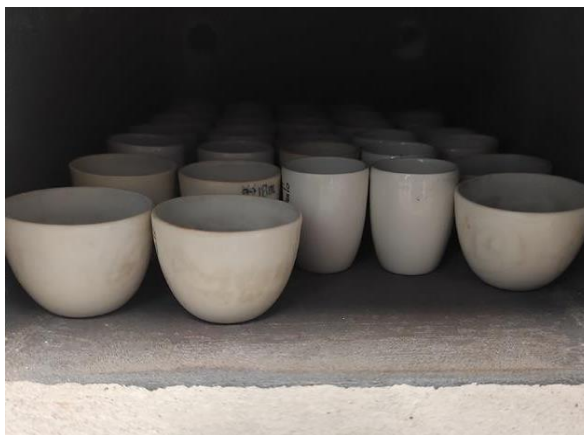
Εικόνα 6 Τοποθέτηση 0.5 g αλεσμένου δείγματος στις κάψες και τοποθέτηση των καψών στο πυραντήριο
