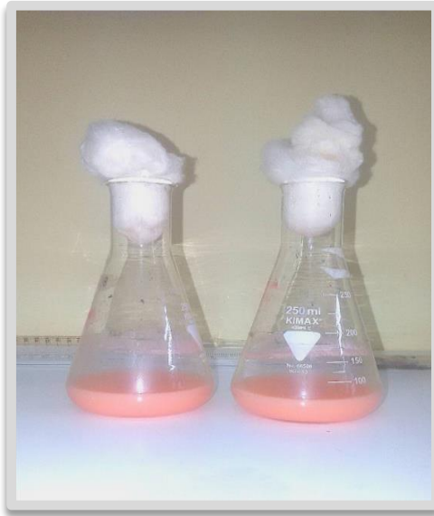
Εικόνα 2.3. Κωνικές φιάλες μετά από 120 h επώασης του μικροοργανισμού Rhodospiridium toruloides στον ανακινούμενο επωαστικό θάλαμο (New Brunswick Sc, USA) σε συνθήκες ανάδευσης 180 rpm και σε θερμοκρασία 28\pm 1 °C, συλλογή νοπής βιομάζας, πριν τοποθετηθεί στον ξηραντήρα.
