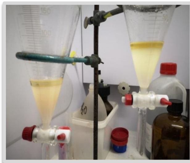
Εικόνα 2.13. Διαχωρισμός δύο φάσεων μετά την προσθήκη εξανίου κατά τη μεθυλεστεροποίηση του μικροοργανισμού Rhodospiridium toruloides .
