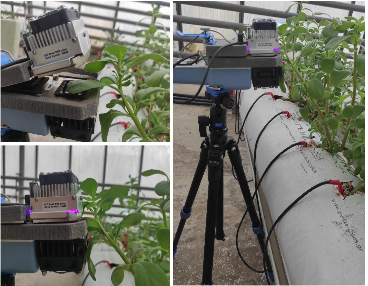
Εικόνα 12. Διαδικασία μέτρησης φωτοσύνθεσης και συναφών φυσιολογικών παραμέτρων
