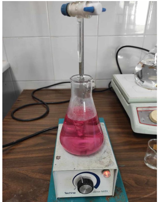
Εικόνα 19. Διαδικασία απόσταξης και τιτλοδότησης για τον προσδιορισμό ολικού αζώτου σύμφωνα με τη μέθοδο Kjeldahl.
