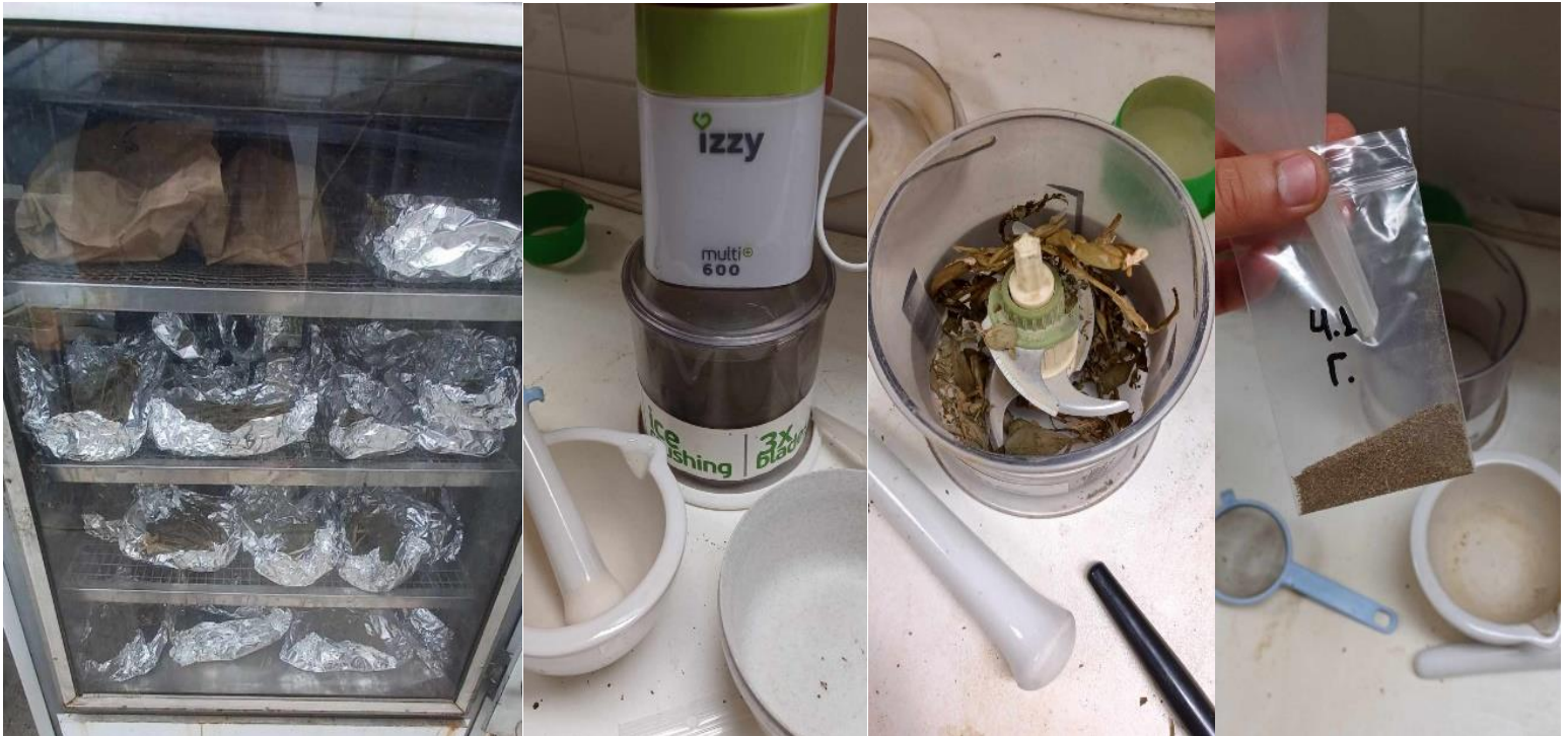
Εικόνα 13. Ξηραντήριο και διαδικασία κονιοροποίησης ξηρών φυτικών δειγμάτων.
