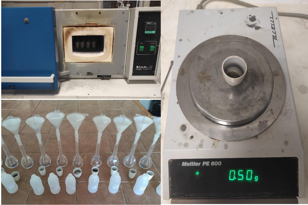
Εικόνα 14. Διαδικασία ζύγισης, καύσης δειγμάτων σε πυραντήριο και διήθησης.
