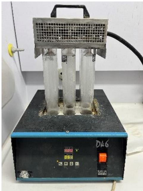
Εικόνα 5: Συσκευή χώνευσης για τον προσδιορισμό της συνολικής περιεκτικότητας πρωτεϊνών.
