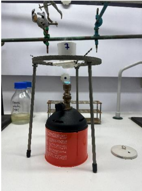
Εικόνα 7: Φλόγα λύχνου Bunsen, τρίγωνο από πυρίμαχο υλικό, το οποίο στηρίζεται πάνω σε τρίποδο.
