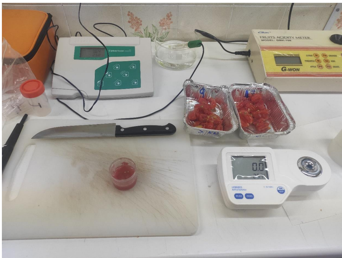
Εικόνα 14. Διαθλασίμετρο για την μέτρηση σακχάρων (κάτω δεξιά), ψηφιακό οξύμετρο (πάνω δεξιά) για την μέτρηση της οξύτητας και ψηφιακό πεχάμετρο για την μέτρηση δείκτη οξύτητας-pH (πάνω αριστερά).
