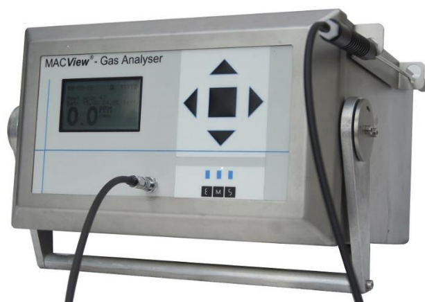
Εικόνα 15. Φορητός μετρητής αιθυλενίου MACView.
