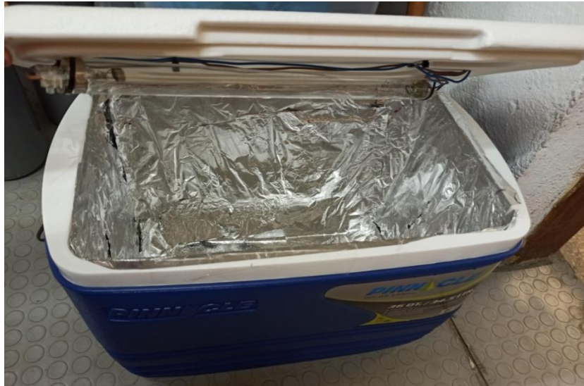
Εικόνα 5 Ισοθερμικό ψυγείο που χρησιμοποιήθηκε για την ακτινοβολήση των δειγμάτων με UV-C.
