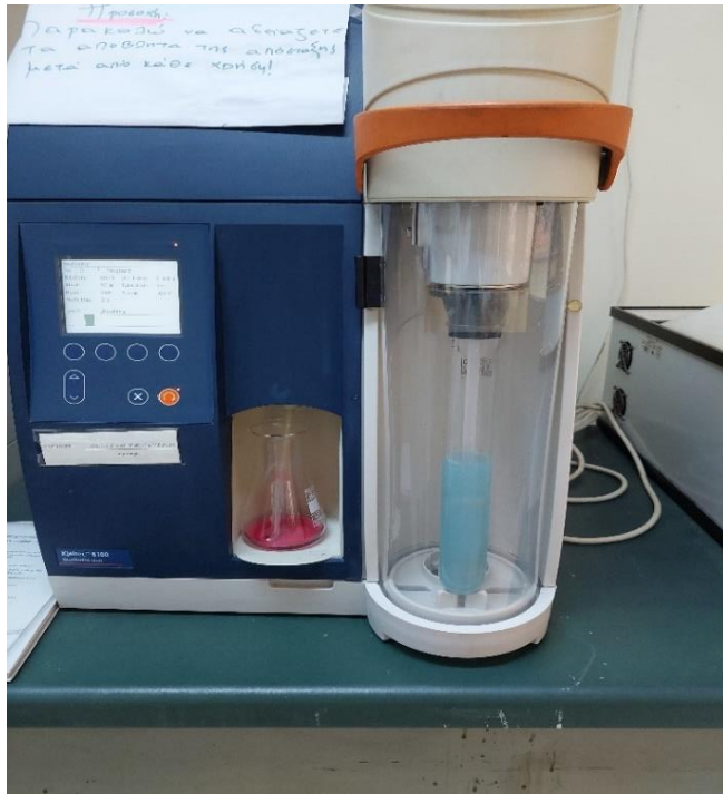
Εικόνα 8: Συσκευή απόσταξης μεθόδου Kjeldahl
