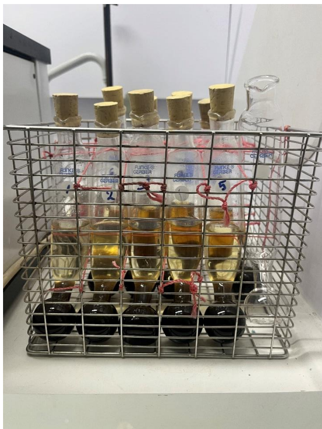
Εικόνα 10: Εκχύλιση με τη χρήση της συσκευής Mojonnier
