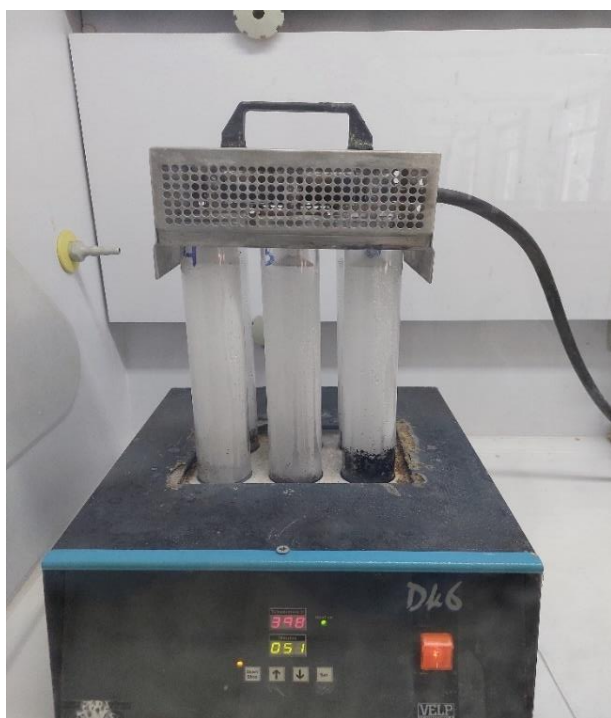
Εικόνα 7: Συσκευή καύσης μεθόδου Kjeldahl
