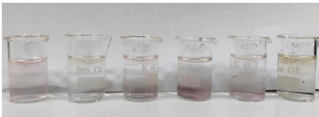
Εικόνα 12 - Εκχύλισμα σε ρυθμιστικά διαλύματα με pH 2, 4, 6, 8, 10 και 12 (από αριστερά προς τα δεξιά)
