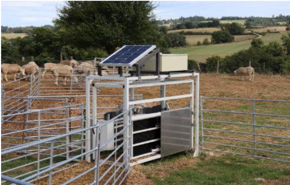
Εικόνα 24: Πλατφόρμα ζύγισης προβάτων με ηλιακούς συλλέκτες [πηγή εικόνων : 22]
