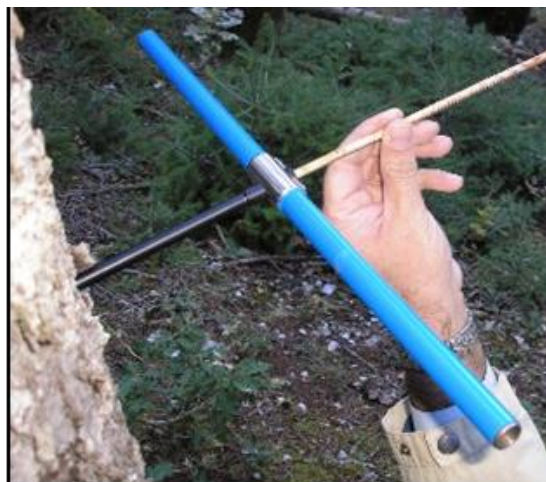
Εικόνα 3.3.1. Λήψη τρυπανιδίου με την τρυπάνη τύπου Pressler
