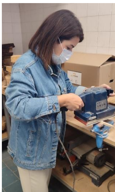
Εικόνα 3.3.2. Λείανση δείγματος με παλμικό τριβείο
