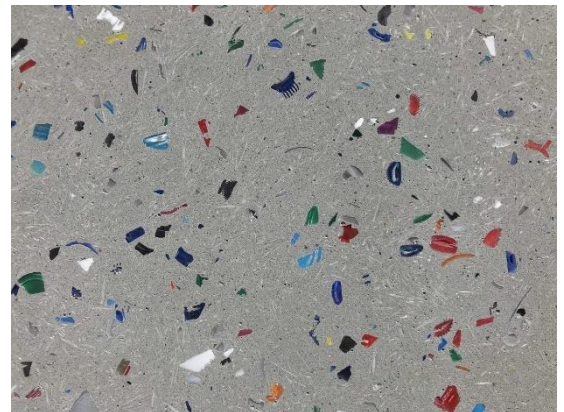
Εικόνα 89 Δείγμα από χυτό μπετό με ενσωματωμένο ανακυκλωμένο πλαστικό από καπάκια.
