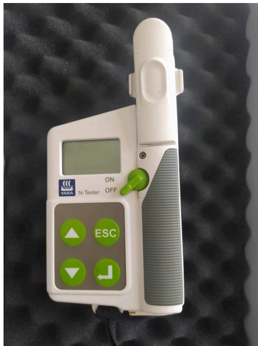
Εικόνα 21: Όργανο μέτρησης συγκέντρωσης χλωροφύλλης (Πηγή: Προσωπικό αρχείο)
