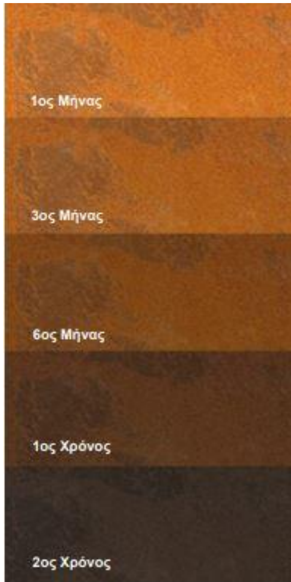
Εικόνα 61: Αλλαγές που υφίσταται το Corten με την πάροδο του χρόνου
