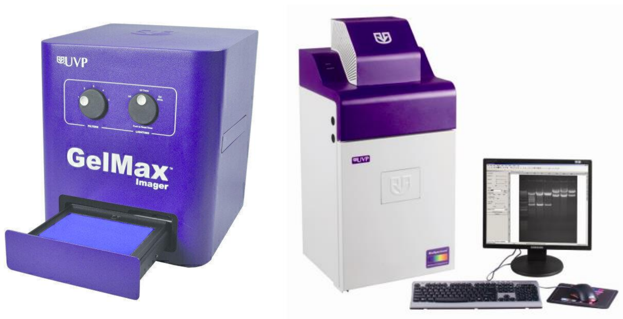
Εικόνα 2.22 Εξειδικευμένο μηχάνημα οπτικοποίησης του πηκτώματος αгарόζης
