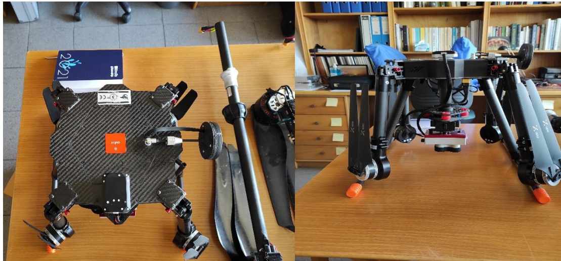
Εικόνα 14: ΣμηΕΑ Mera με κλειστές τις έλικες. (Φωτογραφία του συγγραφέα)
