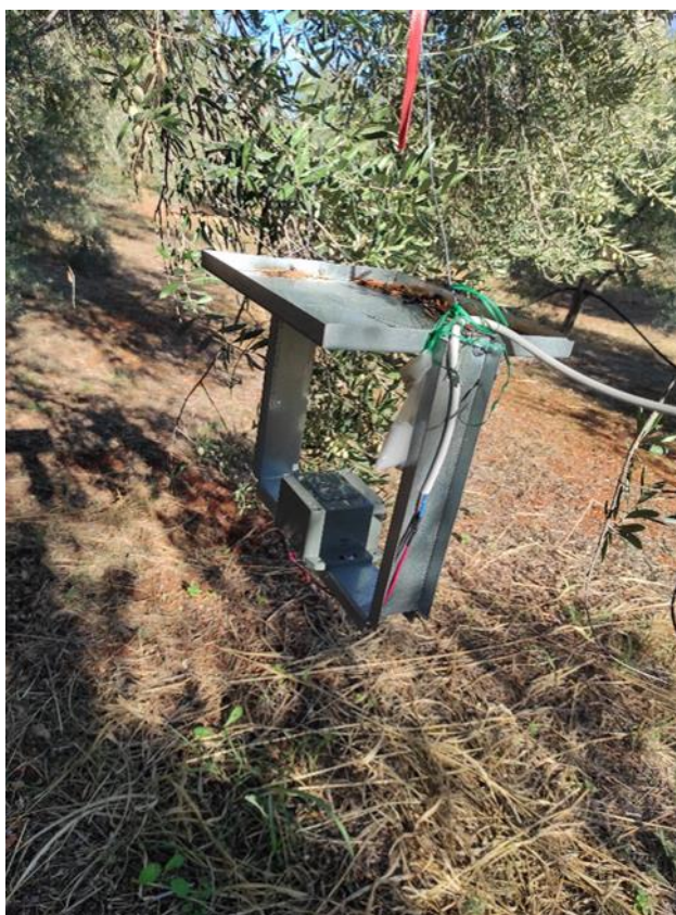
Εικόνα 9: Παγίδα απομακρυσμένη παρακολούθησης με κάμερα 5Μpixels κρεμασμένη σε ελαιόδεντρο. (Φωτογραφία του συγγραφέα)
