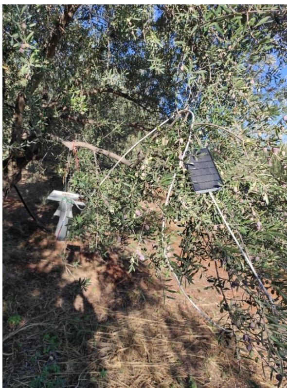
Εικόνα 10: Παγίδα απομακρυσμένης παρακολούθησης με κάμερα 5Μpixels μαζί με το φωτοβολταϊκό κρεμασμένη σε ελαιόδεντρο. (Φωτογραφία του συγγραφέα)
