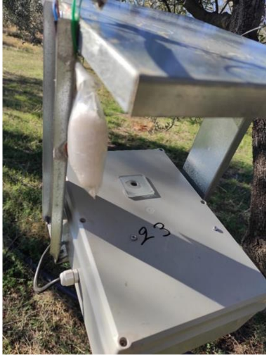
Εικόνα 5: Παγίδα απομακρυσμένης παρακολούθησης με κάμερα 13Μpixels κρεμασμένη σε ελαιόδεντρο. (Φωτογραφία του συγγραφέα)
