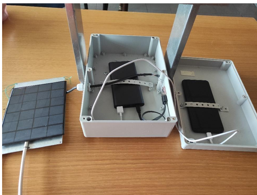
Εικόνα 8: Λεπτομερή αποτύπωση εσωτερικού τμήματος παγίδας απομακρυσμένης παρακολούθησης 13Μpixels. Αριστερά φωτοβολταϊκό που φορτίζει το Power bank που βρίσκεται στη μέση και το οποίο δίνει ενέργεια στο κινητό που βρίσκεται στα δεξιά (Φωτογραφία του συγγραφέα)
