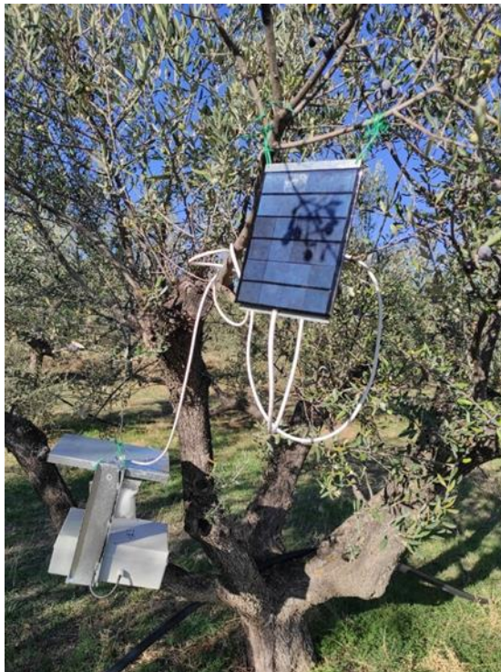
Εικόνα 6: Παγίδα απομακρυσμένης παρακολούθησης με κάμερα 13Μpixels μαζί με το φωτοβολταϊκό κρεμασμένη σε ελαιόδεντρο. (Φωτογραφία του συγγραφέα)
