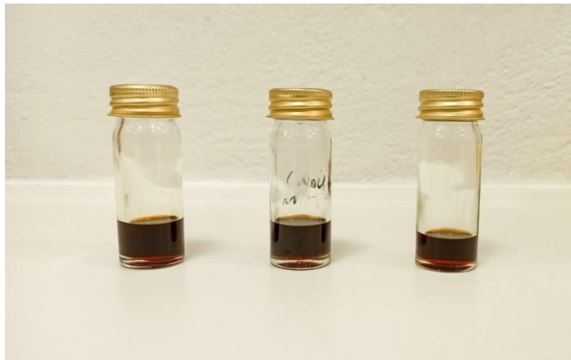
Εικόνα 12. Τελικό προϊόν εστεροποίησης (βιολιπαντικό) του ελαίου.καφέ.
