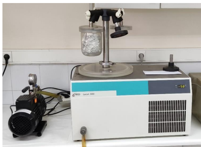
Εικόνα 5 Λυοφυλλιωτής Thermo scientific, Heto Lyolab 3000
