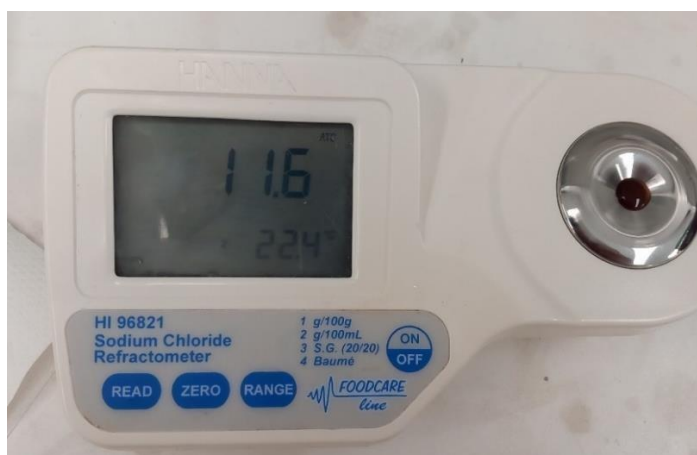
Εικόνα 23: Μέτρηση αλατοπεριεκτικότητας με διαθλασίμετρο
