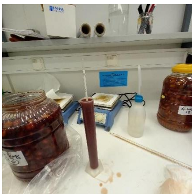
Εικόνα 22: Μέτρηση αλατοπεριεκτικότητας με πυκνόμετρο σε άλμη
