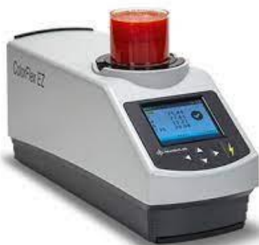
Εικόνα 3.3: Προσδιορισμός χρώματος με HunterLab Colorflex (Πηγή : https://www.hunterlab.com )
