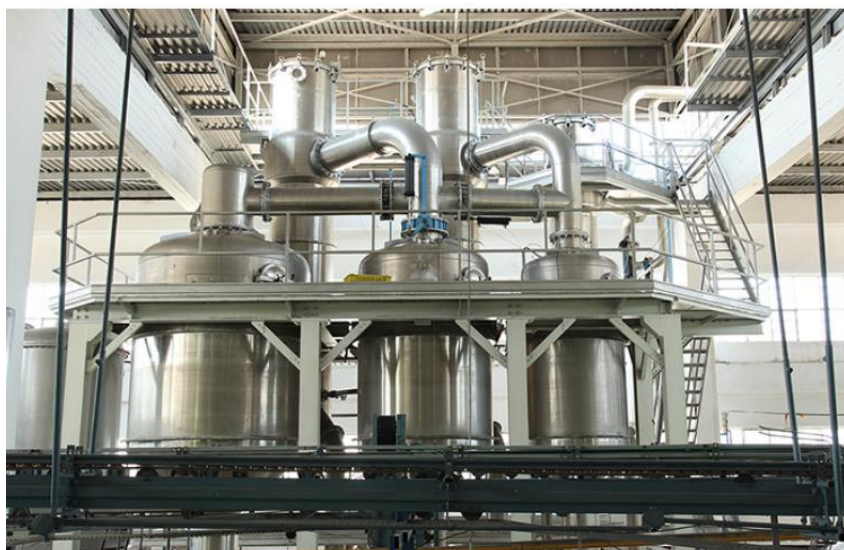
Εικόνα 1.3: Συμπυκνωτής αντίστροφης ροής τοματοχυμού (Πηγή: https://kyknoscanning.com )
