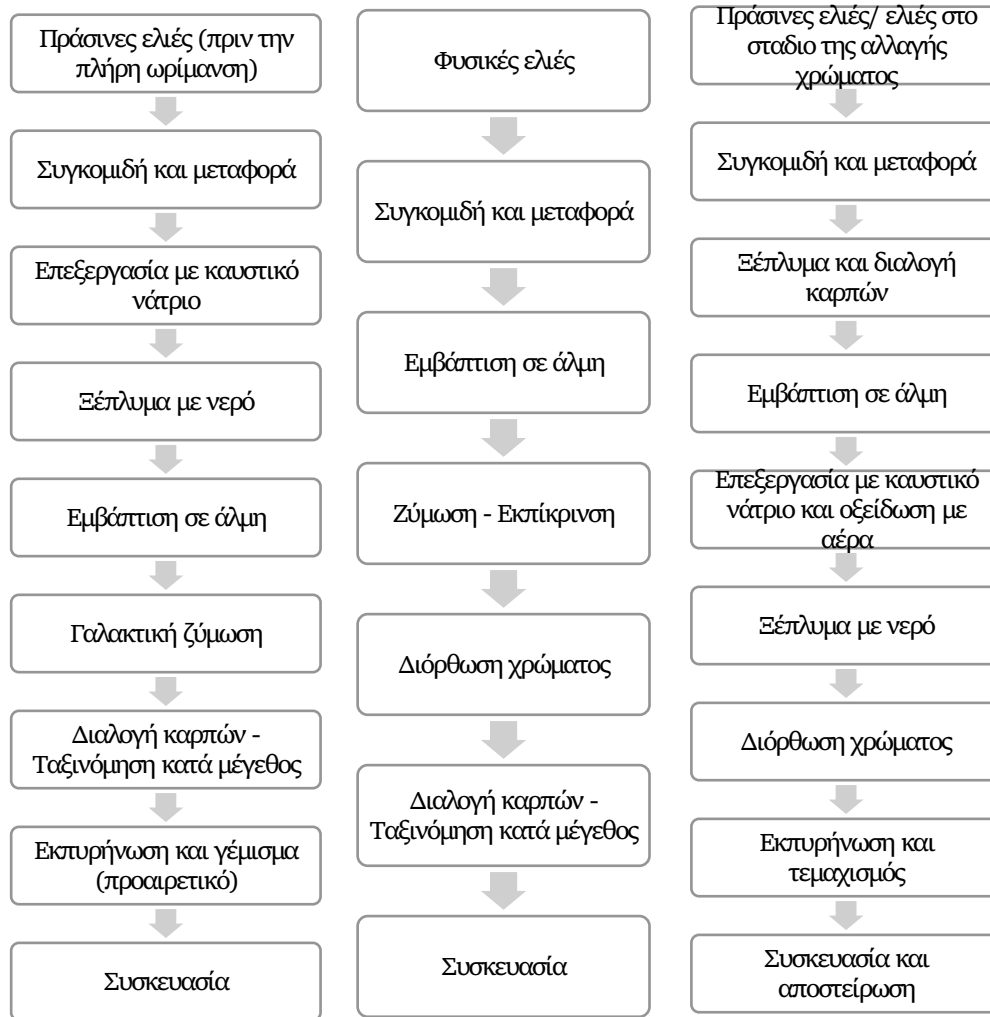
Σχήμα 3.1: Διαγράμματα ροής κατά την παρασκευή των σημαντικότερων εμπορικών τύπων ελιάς. Από τα αριστερά προς τα δεξιά: ελιές ισπανικού τύπου, φυσικές ελιές (ελληνικού τύπου) και ελιές μαυρισμένες με οξείδωση (τύπου Καλιφόρνια). Μετά την συσκευασία ακολουθεί αποθήκευση και εμπορία
