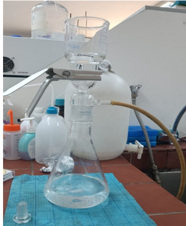
Εικόνα 6.2: Διήθηση κινητής φάσης στη συσκευή διήθησης κενού, Millipore (Πηγή: Προσωπικό αρχείο)
