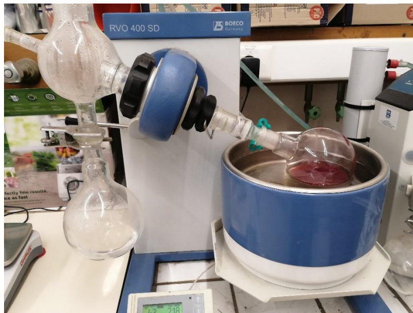
Εικόνα 15: Συμπύκνωση εκχυλίσματος με χρήση περιστρεφόμενου συμπυκνωτή.
