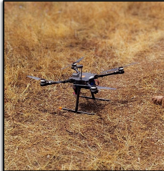
Εικόνα 28. Το ΣμηΕΑ Mera της εταιρείας UcanDrone με το οποίο πραγματοποιήθηκε η πτήση για τη λήψη εικόνων μέσω της προσαρτημένης πολυφασματικής κάμερας (Επεξεργασία από Αναγνώστου Μαριάνθη).
