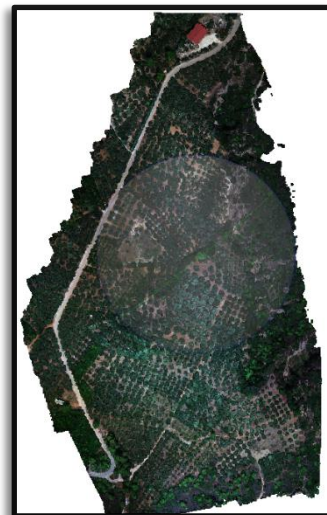
Εικόνα 35. Το πυκνό νέφος σημείων (dense point cloud) που δημιουργήθηκε στο πρόγραμμα Agisoft Metashape. Με βάση το πυκνό νέφος θα κατασκευαστεί έπειτα το 3D μοντέλο DEM (Φωτογραφία του προγράμματος Metashape από Αναγνώστου Μαριάνθη)
