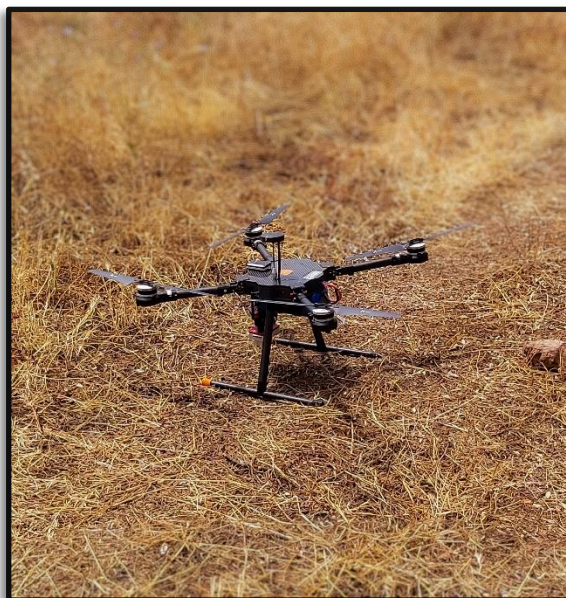
Εικόνα 26. Το ΣμηΕΑ Mera της εταιρείας Ucadrone με το οποίο πραγματοποιήθηκε η πτήση για τη λήψη εικόνων μέσω της προσαρτημένης πολυφασματικής κάμερας (Επεξεργασία από Αναγνώστου Μαριάνθη).
