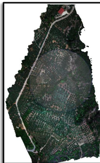
Εικόνα 35. Το πυκνό νέφος σημείων (dense point cloud) που δημιουργήθηκε στο πρόγραμμα Agisoft Metashape. Με βάση το πυκνό νέφος θα κατασκευαστεί έπειτα το 3D μοντέλο DEM (Φωτογραφία του προγράμματος Metashape από Αναγνώστου Μαριάνθη).
