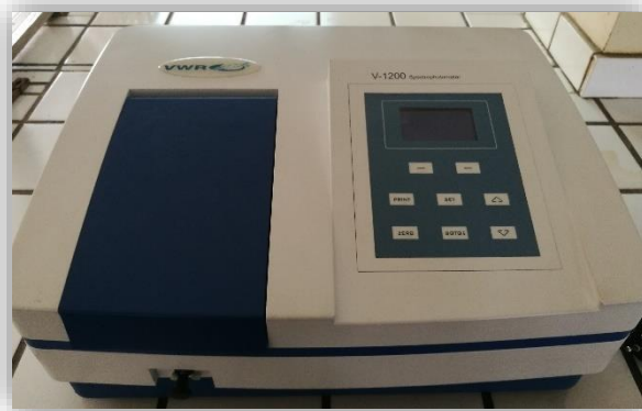
Εικόνα 13 : Το φωτόμετρο UV που χρησιμοποιήθηκε
