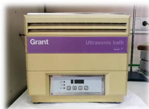
Εικόνα 10 : Λουτρό υπερήχων συχνότητας 35KHz
