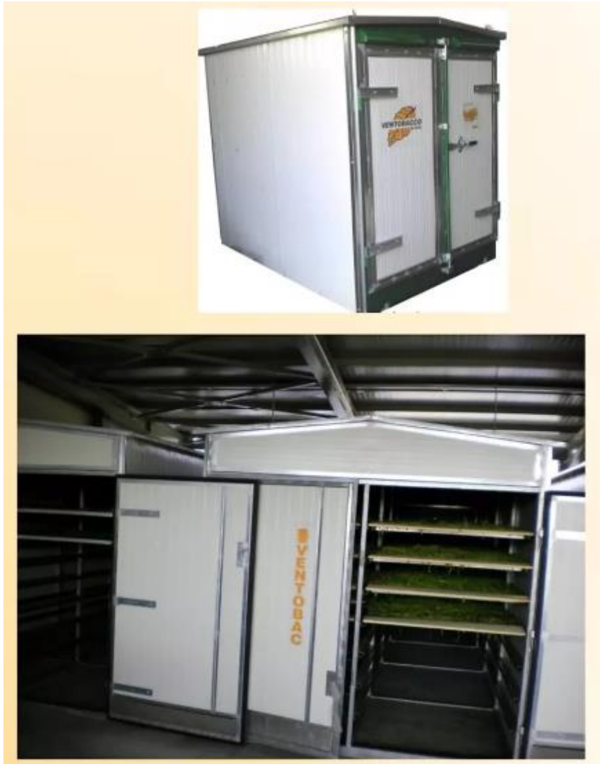
Εικόνα 6. Εικόνα ξηραντηρίου ΦΑΦ
