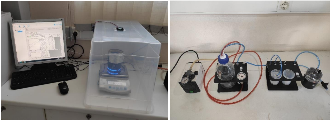
Εικόνα 22. Συσκευή προσδιορισμού υδραυλικών ιδιοτήτων εδάφους - HYPROP2. Κεντρική μονάδα (αριστερά) και μονάδα πλήρωσης νερού (δεξιά).
