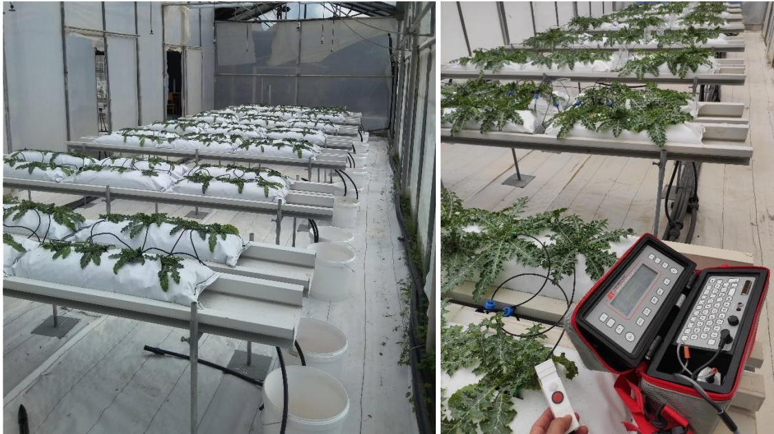
Εικόνα 31. Συλλογή και καταγραφή κλάσματος απορροής (αριστερά) από κάθε πειραματικό τεμάχιο (κανάλια υποδοχής των σάκων) και εκτίμηση στοματικής αγωγιμότητας (δεξιά) με χρήση οργάνου AP4 (Delta-T Devices, Cambridge, UK).
