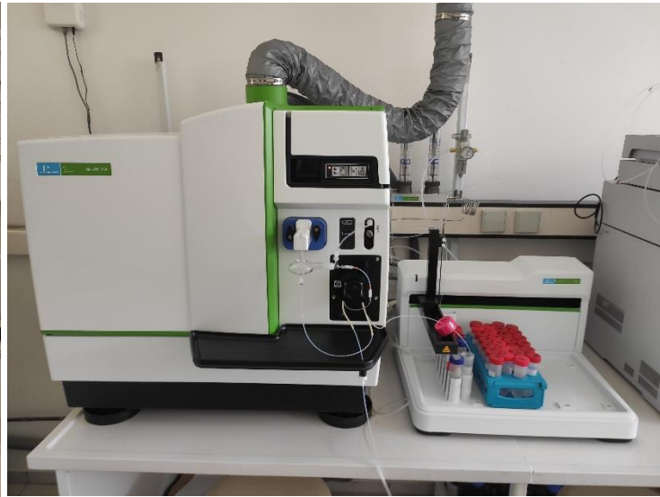
Εικόνα 33. Προσδιορισμός οργανικού αζώτου στους φυτικούς ιστούς με τη μέθοδο Kjeldahl μετά την ανοργανοποίηση με H_2SO_4 (αριστερά) και εκτίμηση των συγκεντρώσεων P, K, Ca και Mg από τα ληφθέντα υδατικά εκχυλίσματα με χρήση οργάνου ICP-MS (NexION 2000, PerkinElmer) (δεξιά).
