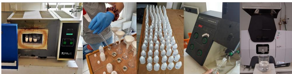
Εικόνα 10: Διαδικασία εκχύλισης των φυτικών ιστών για τον προσδιορισμό των μακρο- και ιχνοστοιχείων με φλογοφωτόμετρο και ατομική απορρόφηση.
