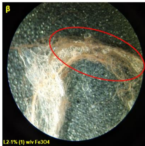
Εικόνα 122: α) Παρασκεύασμα σε αντικειμενοφόρο πλάκα με καλυπτρίδα από ίνες μεταξιού μεταξοσκώληκα της ομάδας L2 στη δόση 1% (1 η επανάληψη) w/v Fe 3 O 4 NPs, β) Λεπτομέρεια ιών μεταξιού μεταξοσκώληκα από την ομάδα L2 στη δόση 1% (1 η επανάληψη) w/v Fe 3 O 4 NPs μέσω της χρήσης στερεοσκοπίου (με κόκκινο οι ενδείξεις της τροποποιημένης ίνας μεταξιού).
