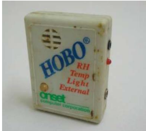
Εικόνα 43: Ηλεκτρονικός καταγραφέας για δεδομένα τύπου HOBO - RH/Temp/Light/External Data Logger-H08-004-02 (Onset Computer Corporation, MA, USA)
