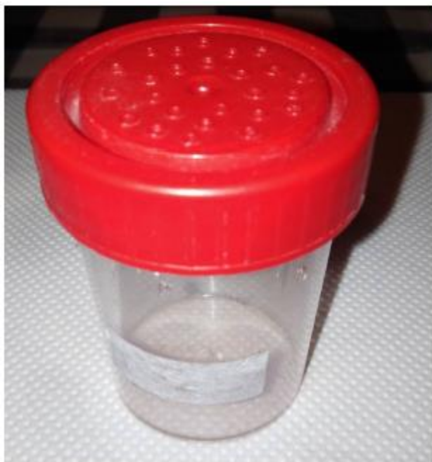
Εικόνα 61: Κυλινδρικό πλαστικό δοχείο δειγματοληψίας με καπάκι με οπές (3,5x6,5 cm) για απομόνωση των νυμφών του μεταξοσκώληκα.
