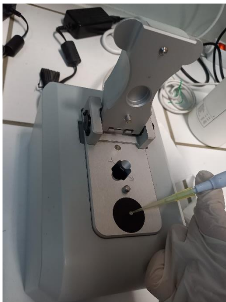
Εικόνα 2.16. Προσδιορισμός της συγκέντρωσης του RNA με τη χρήση φασματοφωτομέτρου NanoDrop.
