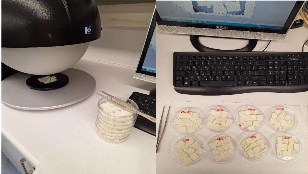
Εικόνες 2.4: Διαδικασία λήψης πολυφασματικών εικόνων με το όργανο VideometerLab.
