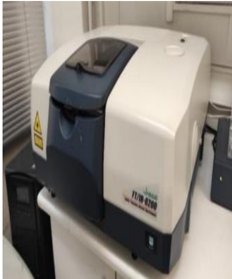
Εικόνα 2.10: Εξωτερική απεικόνιση του οργάνου FTIR- 6200 JASCO (αριστερά). Δείγμα τοποθετημένο στην κρύσταλλο ZnSe 45° HATR, καλυμμένο με φύλλο αλουμινίου, έτοιμο για την μέτρηση (δεξιά).
