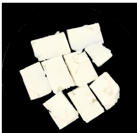
Εικόνα 2.8: Απεικόνιση δειγμάτων φέτας μετά την χρήση του VideometerLab και κατόπιν απομόνωσης της περιοχής ενδιαφέροντος (ROI).
