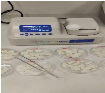
Εικόνα 2.11: Μέτρηση ενεργότητας ύδατος ( a_w ) με χρήση του οργάνου Dew Point Water Activity Meter 4TE.
