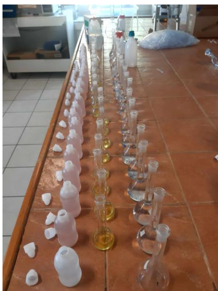
Εικόνες 1.32 Εμφανής αλλαγή χρώματος μετά που βάλामε τα διάφορα αντιδραστήρια για τον εντοπισμό του φωσφόρου
