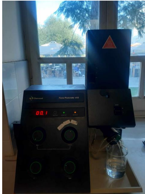
Εικόνα 1.34 Μηχάνημα φλογοφωτόμετρου, Flame Photometer 410, που χρησιμοποιήθηκε για την μέτρηση του καλίου και του νατρίου
