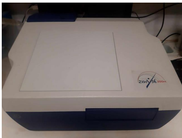
Εικόνα 1.31 Φασματοφωτόμετρο, Anthos zenith 200rt, που χρησιμοποιήθηκε για την μέτρηση των νιτρικών
