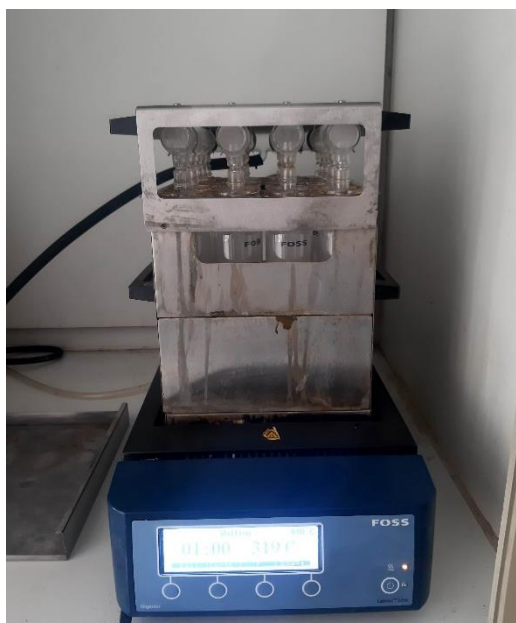
Εικόνα 1.39 Μηχάνημα Labtec SR 210, για χώνευση (αριστερά) και απόσταξη (δεξιά) δείγματος για τον προσδιορισμό του ολικού αζώτου
