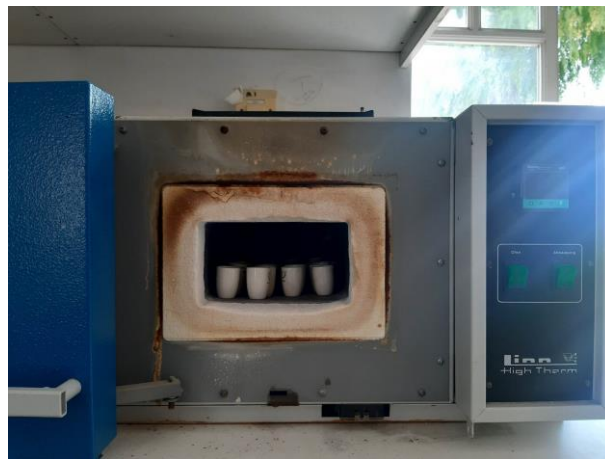
Εικόνα 1.37 Μηχάνημα LM-112, Linn High Therm που χρησιμοποιήθηκε για την δημιουργία τέφρας
