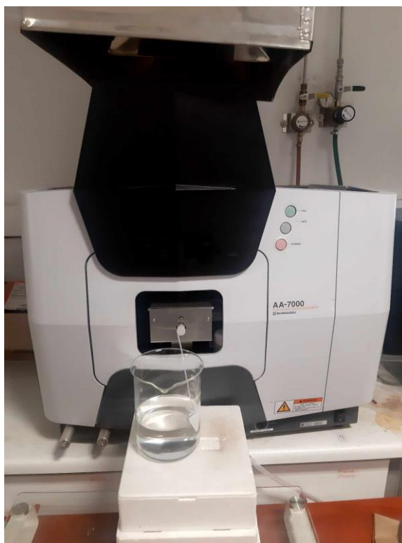
Εικόνα 1.33 Μηχάνημα ατομικής απορρόφησης, AA – 7000, που χρησιμοποιήθηκε για τη μέτρηση του ασβεστίου και του μαγνησίου
