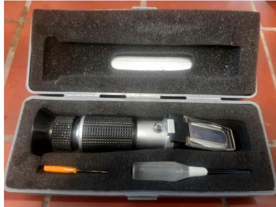
Εικόνα 1.40 Διαθλασίμετρο που χρησιμοποιήθηκε για την μέτρηση των διαλυτών στερεών συστατικών (°Brix), ονομασία: Schmidt & Haensch HR32B
