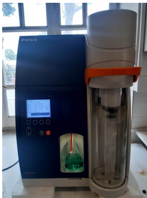
Εικόνα 1.38 Μηχάνημα Tecator Kjeltac 8200 για τον προσδιορισμό του ολικού αζώτου
