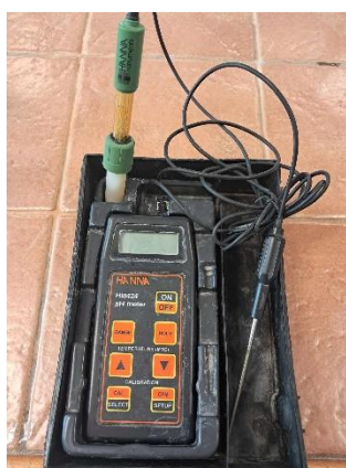
Εικόνα 1.5 Φορητό όργανο για την μέτρηση του pH, ονομασία φορητού οργάνου: HI8424
