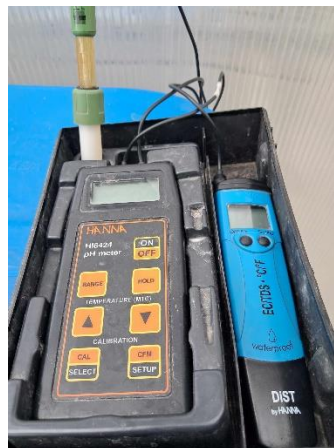
Εικόνα 1.35 Φορητό όργανο μέτρησης pH (αριστερά) και EC (δεξιά)
