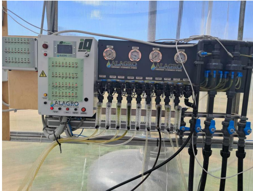
Εικόνα 1.10 Σύγχρονη κεφαλή υδρολίπανσης, σε ηλεκτρονικό σύστημα, για τη σύνθεση του θρεπτικού διαλύματος
