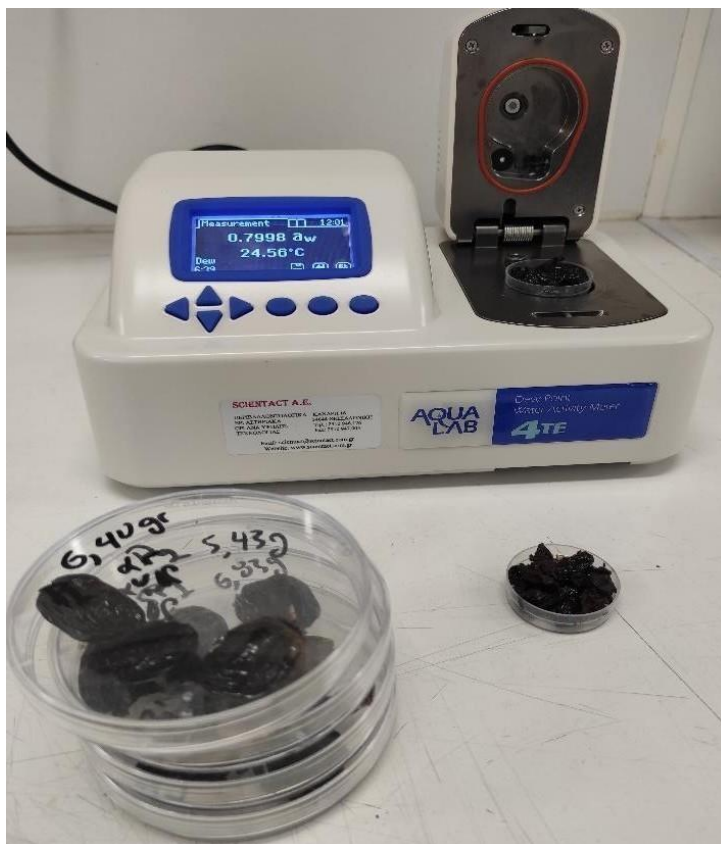
Εικόνα 3.8: Αισθητήρας μέτρησης ενεργότητας AQUALAB 4TE.
