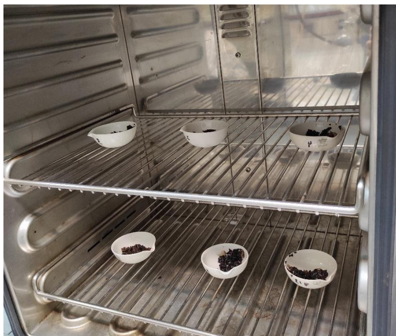
Εικόνα 3.12: Ξήρανση πάστας ελιάς σε φούρνο στους 105 °C για 24 ώρες.
