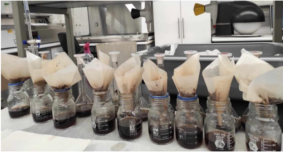
Εικόνα 3.10: Μέθοδος διήθησης του διαλύματος πάστας ελιάς, με τη χρήση διηθητικού χαρτιού.
