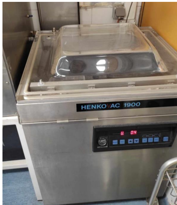
Εικόνα 3.4: Συσκευή διοχέτευσης αερίων (Henkonac 1900)
