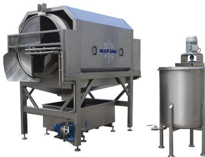
Εικόνα 26. RC.500 - Περιστερόμενο τύμπανο επικάλυψης κομμένων
