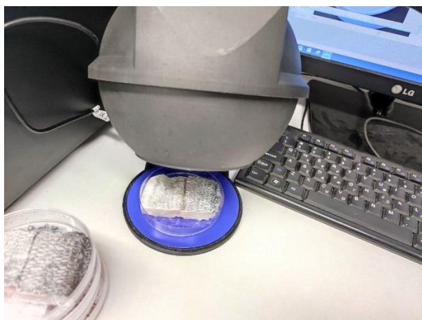
Εικόνα 2.14: Η διαδικασία της απεικόνισης δείγματος φιλέτου τσιπούρας τη χρονική στιγμή πριν την περικύλιση του δείγματος στη σφαίρα της συσκευής προς απεικόνιση. Για τη διαδικασία της απεικόνισης ως φόντο χρησιμοποιούνταν μπλε χρώματος δισκίο ενώ για τη βαθμονόμηση, δισκίο χρώματος λευκού.
