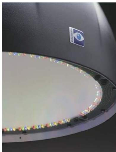
Εικόνα 2.16: Απεικόνιση του εσωτερικού της σφαίρας της συσκευής Videometer lab. Η εικόνα υποδεικνύει την τοποθέτηση των διαφορετικών διόδων της φωτεινής ακτινοβολίας για τα διάφορα μήκη κύματος και τη λευκή εσωτερική επίστρωση της κοιλότητας (Carstensen et al., 2006b).
