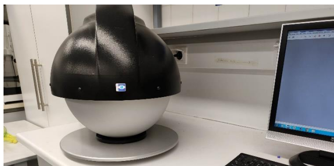
Εικόνα 2.12: Η συσκευή πολυφασματικής απεικόνισης Videometer lab2 που χρησιμοποιήθηκε για τη διεξαγωγή των πειραμάτων.
