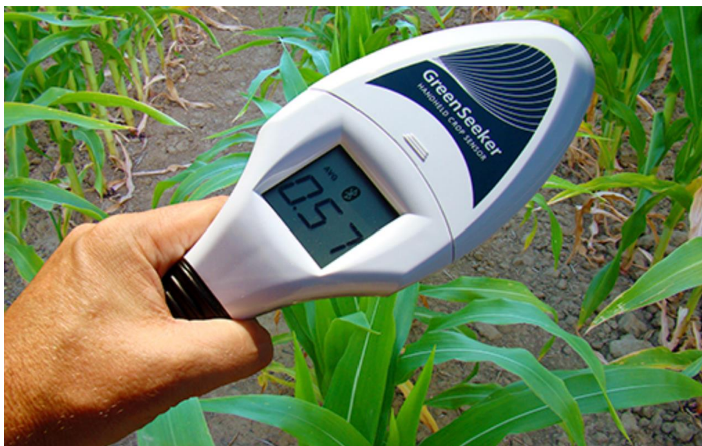
Εικόνα 11. Συσκευή υπολογισμού και αποτύπωσης του δείκτη NDVI 5
