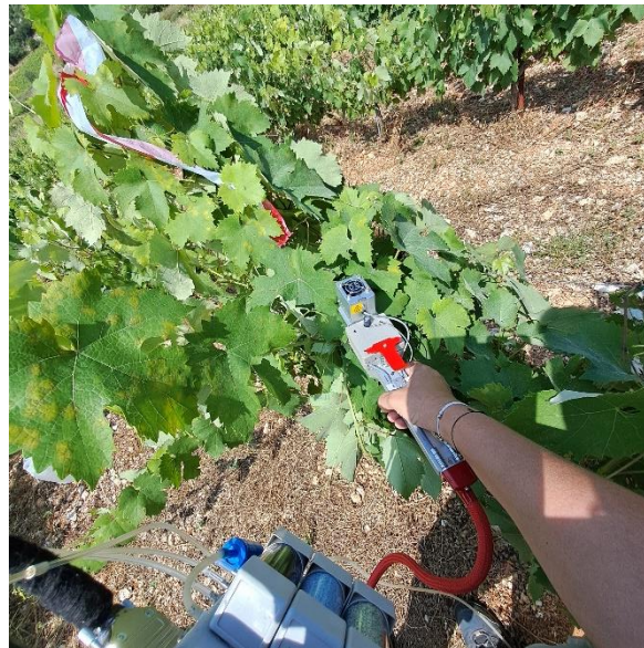
Εικόνα 17: Μέτρηση φωτοσύνθεσης στον αμπελώνα
