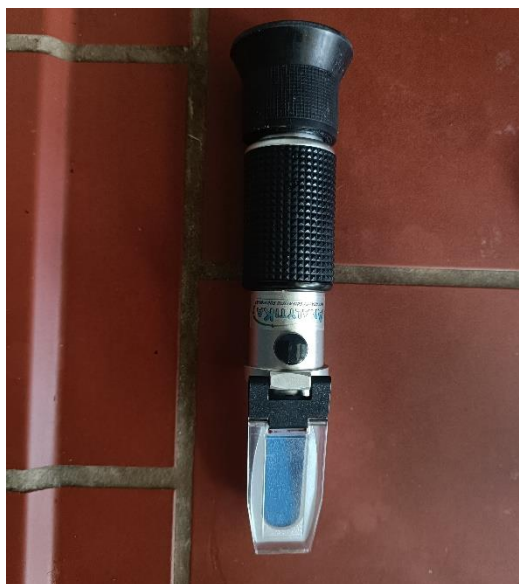
Εικόνα 8: Διαθλάσιμετρο (Εργαστήριο Αμπελογαίας, Γ.Π.Α.)
